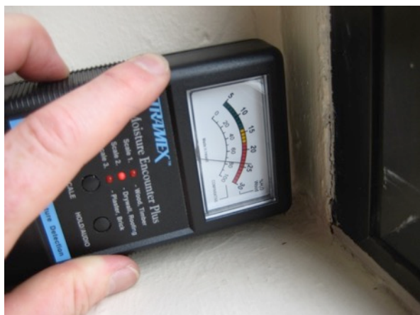
Fig. 3.73: High Moisture @ Jamb Bott.
